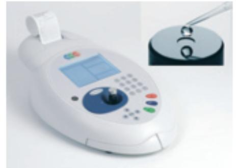
Darüber hinaus sind auch Messungen mit Standard- und Ultramikroküvetten möglich. Der Konzentrationsbereich für dsDNA liegt bei 15 bis 4.250 ng/µl. Der Wellenlängenbereich für einen kompletten Scan reicht von 200 nm bis 950 nm, der für Einzel- oder Mehrfachwellenlängenmessungen von 190 nm bis 1100 nm.
