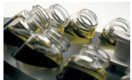
Die Konstruktion der neuen Kühlfalle Speed Trap verbessert die Leistungen von miVac-Geräten erheblich, indem sie Dämpfe zu Flüssigkeiten kondensiert, die Aufrechterhaltung eines starken Vakuums unterstützt und den Einengungsprozeß stark beschleunigt.
